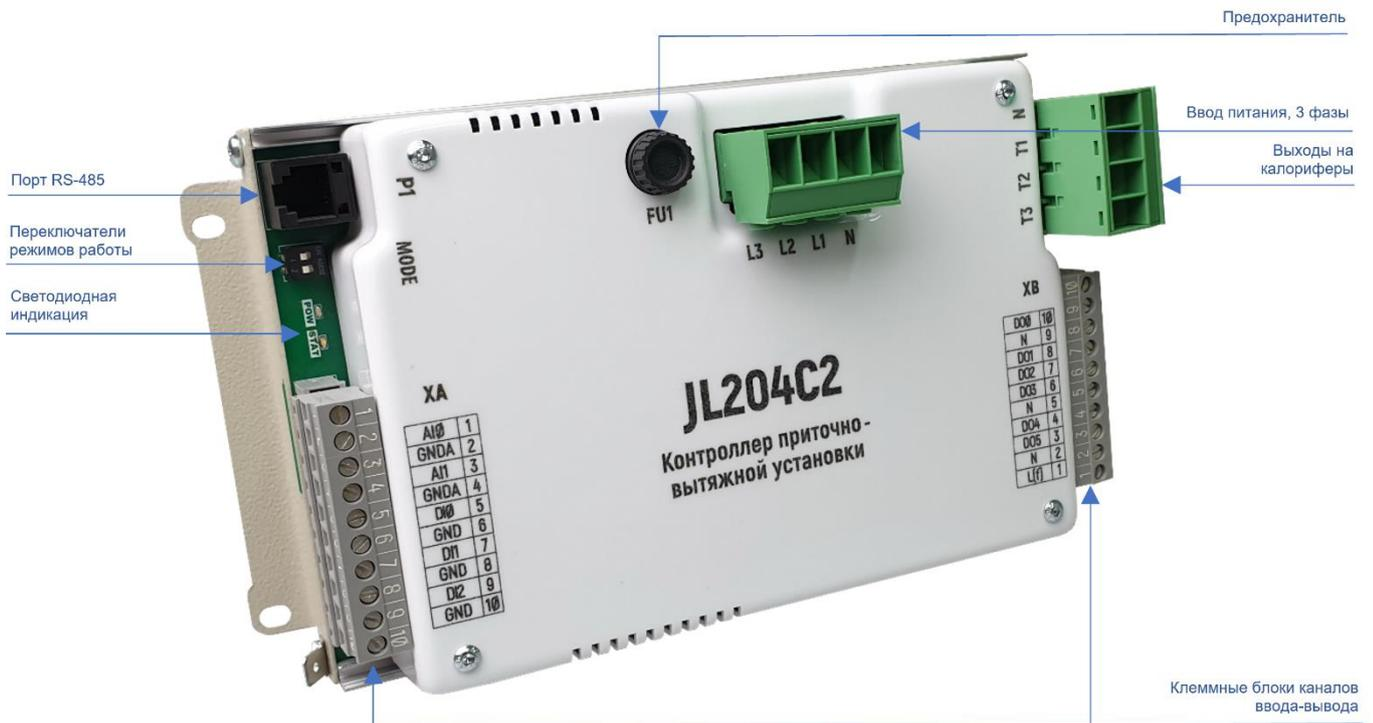
Рисунок 2.1 - Расположение элементов на корпусе
